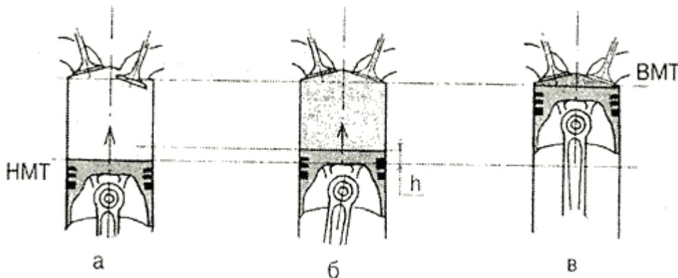
При движении поршня их нижней мертвоточки (а) давление начинает повышаться только после закрытия впускного клапана (б) и достигает максимума в верхней мертвоточке (в):  $h$  - перемещение поршня, при котором давление в цилиндре не повышается
