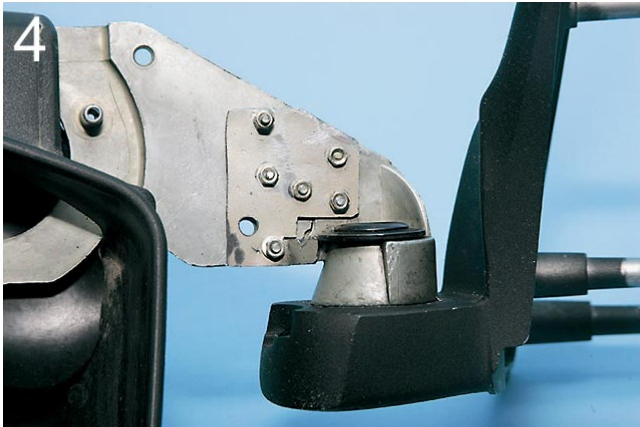
Рис. 3 и 4. Так выглядит с двух сторон место соединения обломков кронштейна с накладками. Чтобы в дальнейшем из-за вибраций не отвернуть винты и гайки, лучше зафиксировать их kleem, например, эпоксидным. Теперь необходимо аккуратно провести отремонтированную часть через «окно» пластмассового корпуса. Не забудем об ориентации, чтобы не получилось «задом наперед».
