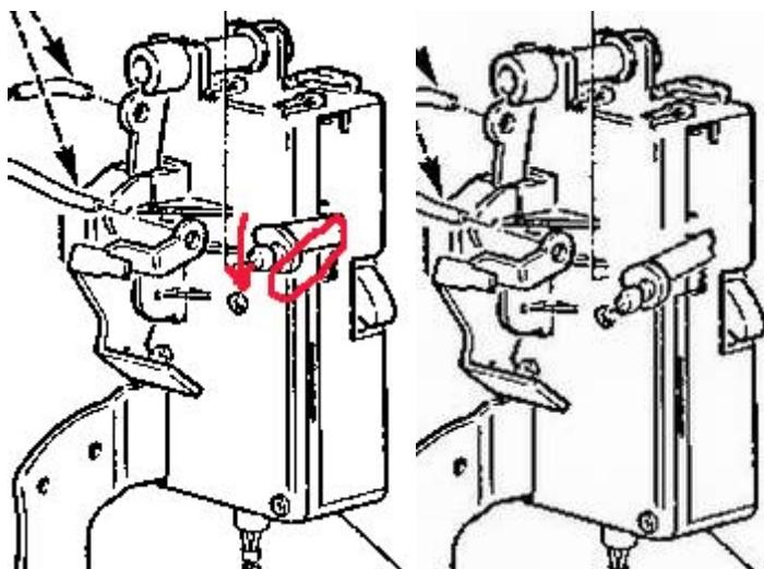
Рис. 1 - нормальный рычаг (красным показано положение, в которое гнется рычаг);
