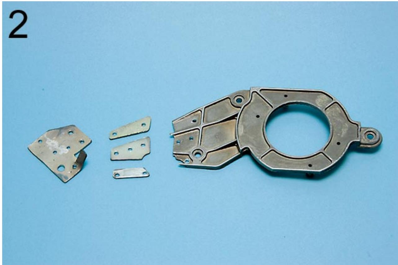
Рис. 2. Соединить две части кронштейна можно по-разному. Мы выбрали то, что доступней. Состыковав обломки, вырезали из картона шаблоны накладок, затем сделали их из листовой сталь толщиной 1 мм. Собрали весь «пакет» и засверлили под винты М3. Результат вы видите: три накладки с одной стороны, а четвертая, большая, - с противоположной.
