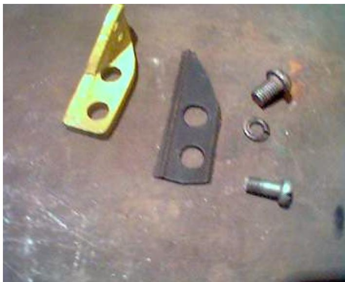
Два отверстия M8 под крепеж и одно - чтобы было за что придерживать. Я, в частности, закручивал туда еще один винт, чтобы жестко ее держать, когда закручиваешь остальные винты. Потом этот винт убирается. Также за это отверстие можно ее привязать или подцепить крючком в случае падения вниз капота. Достается без проблем.
