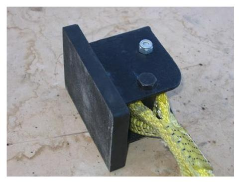
Корпус сварен из листовой стали толщиной 5мм.
