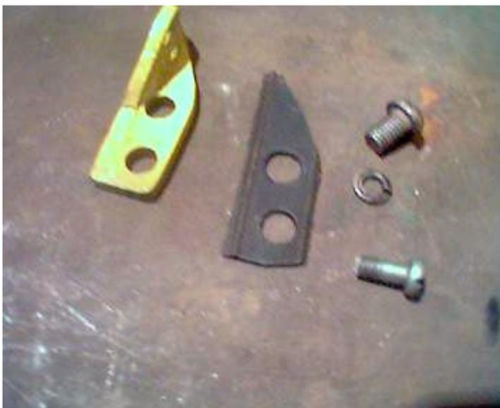
Два отверстия М8 под крепеж и одно - чтобы было за что придерживать. Я, в частности, закручивал туда еще один винт, чтобы жестко ее держать, когда закручиваешь остальные винты. Потом этот винт убирается. Также за это отверстие можно ее привязать или подцепить крючком в случае падения вниз капота. Достается без проблем.
