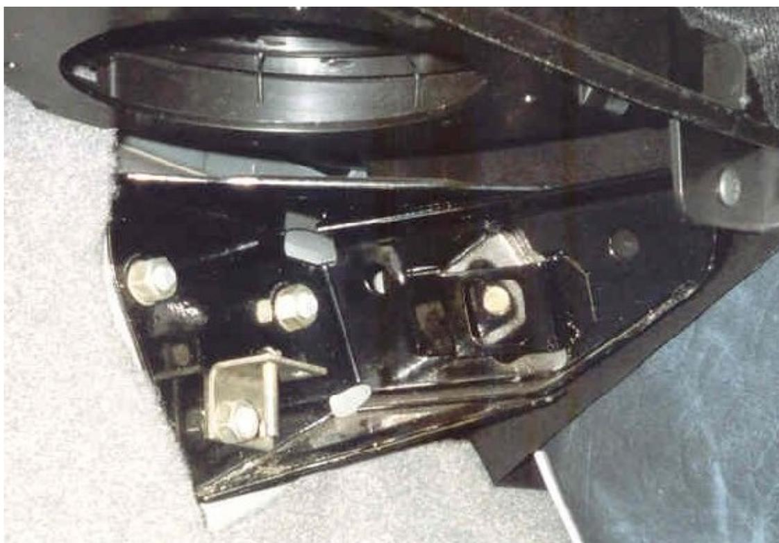
Закручиваю родную гайку назад на шпильку. Вставляю органайзер. Потом просовываю сверху
