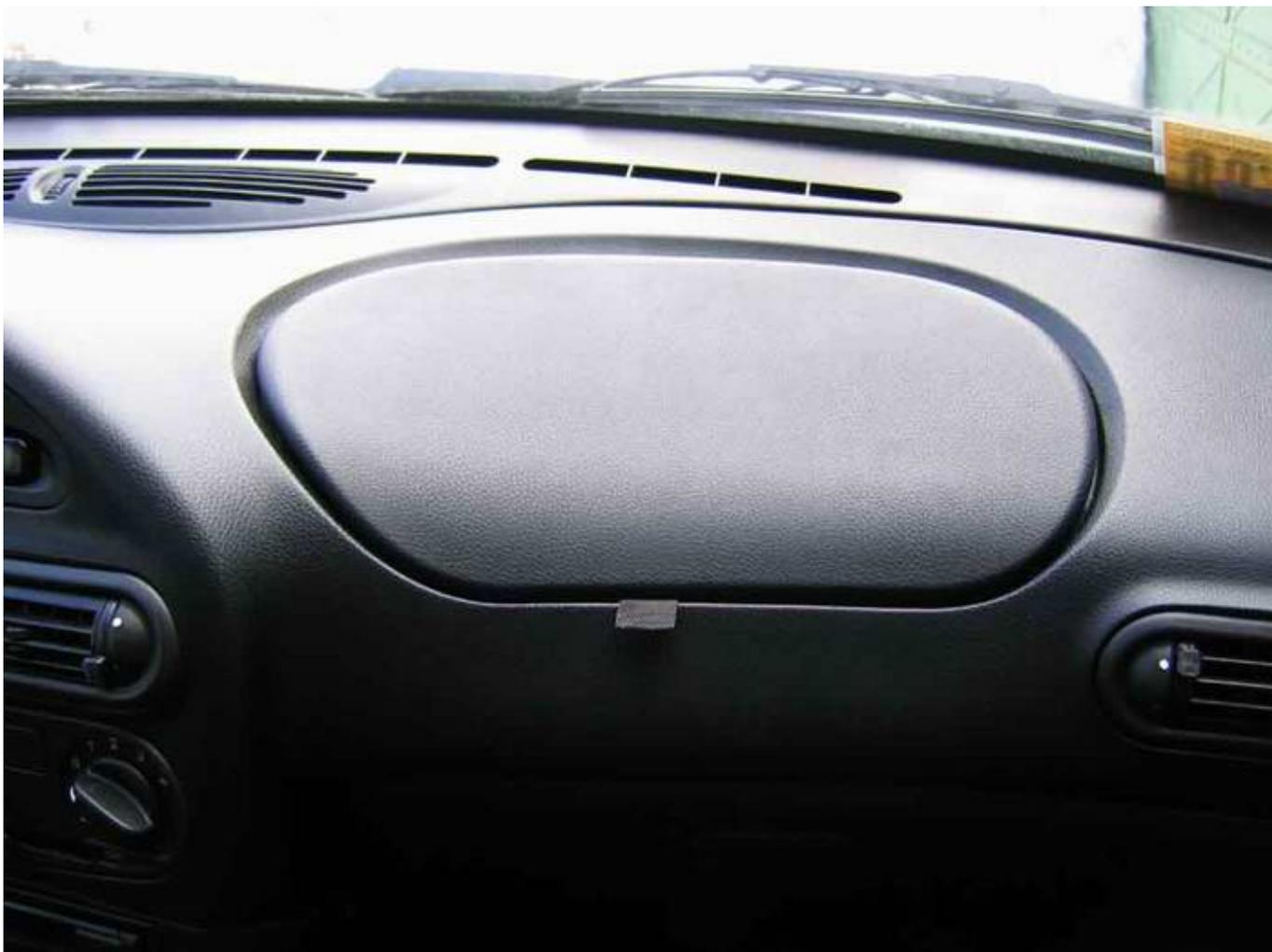
Поначалу я сомневался в бесшумности конструкции, особенно при переезде неровностей на большой скорости. Но, как оказалось, крышка, не имеющая фиксатора, в движении не дребезжит и не открывается. Для бесшумного, «солидного» закрывания крышки, на два крайних пятючка (куда закручивались ранее саморезы) приклеил кругляши пористой резины (от коврика для мыши). В качестве замка можно применить небольшие магнетики.
