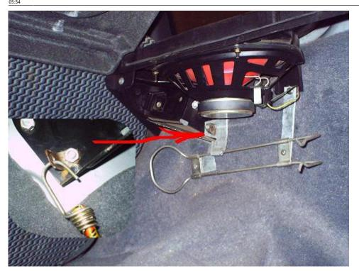
А) сверху приладил огнетушитель белорусского производства (на фото только его крепление) - марку уже не помню на двух кронштейнах из листового металла (я делал их из обычного оцинкованного кровельного железа, а народу рекомендую найти железо толщиной 1 - 1,5 мм). Кронштейны крепятся к шпилькам, которые держат полку. Чертеж кронштейнов прилагается.
