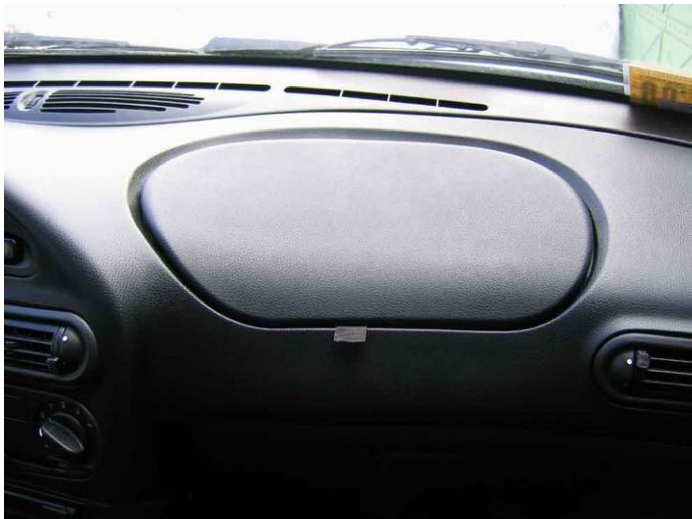
Поначалу я сомневался в бесшумности конструкции, особенно при переезде неровностей на большой скорости. Но, как оказалось, крышка, не имеющая фиксатора, в движении не дребезжит и не открывается. Для бесшумного, «солидного» закрывания крышки, на два крайних пяточки (куда закручивались ранее саморезы) приkleил кругляши пористой резины (от коврика для мыши). В качестве замка можно применить небольшие магнитики.
