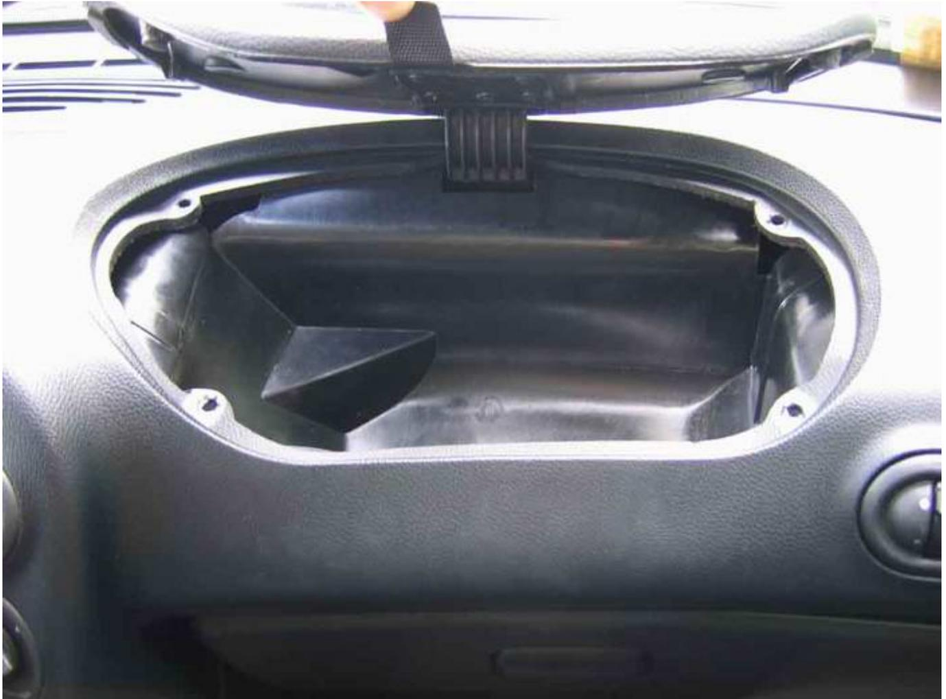
Для удобства монтажа придется снять штатный бардачок.
