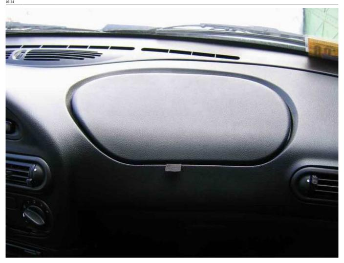
Поначалу я сомневался в бесшумности конструкции, особенно при переезде неровностей на большой скорости. Но, как оказалось, крышка, не имеющая фиксатора, в движении не дребезжит и не открывается. Для бесшумного, «солидного» закрывания крышки, на два крайних пяточка (куда закручивались ранее саморезы) приклеил кругляши пористой резины (от коврика для мыши). В качестве замка можно применить небольшие магнитики.
