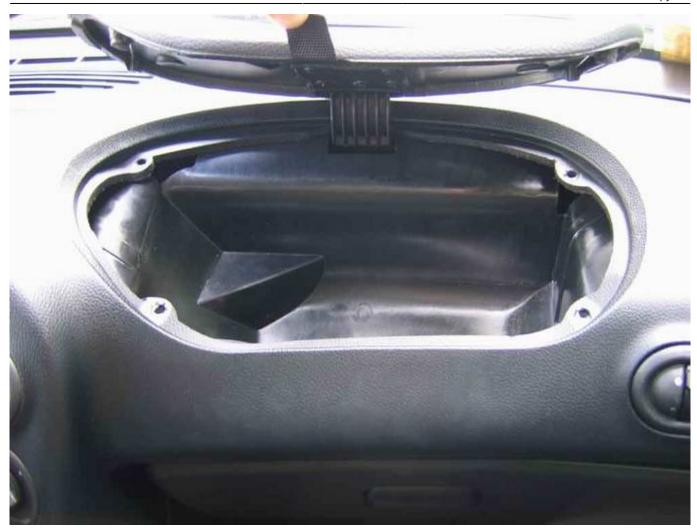
Для удобства монтажа придется снять штатный бардачок.
