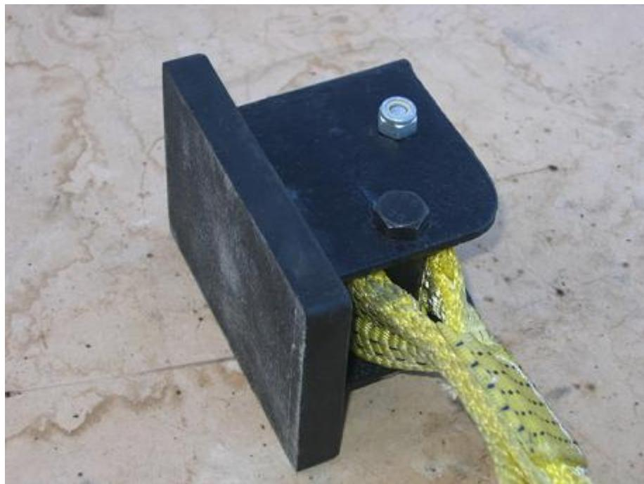
Корпус сварен из листовой стали толщиной 5мм.
