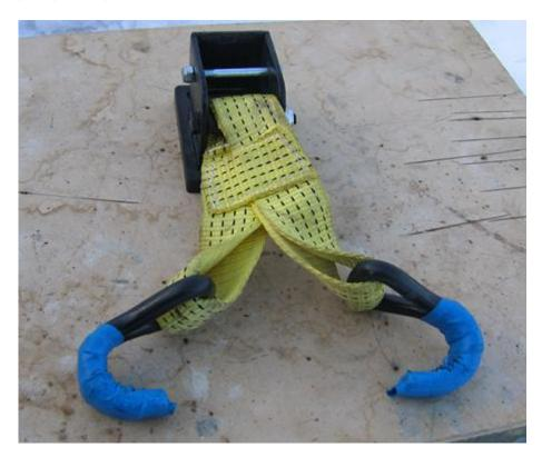
Общий вид. Крюки в пластике, чтобы не царапать диски колес. Заявленная грузоподъемность 2268кг.
