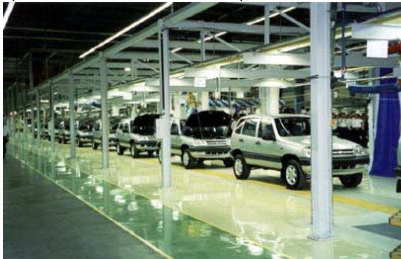
Потом идет участок по проверке кузова автомобиля. Если с ним все в порядке, то тогда автомобиль поднимается на подвесной конвейер и перемещается дальше.
