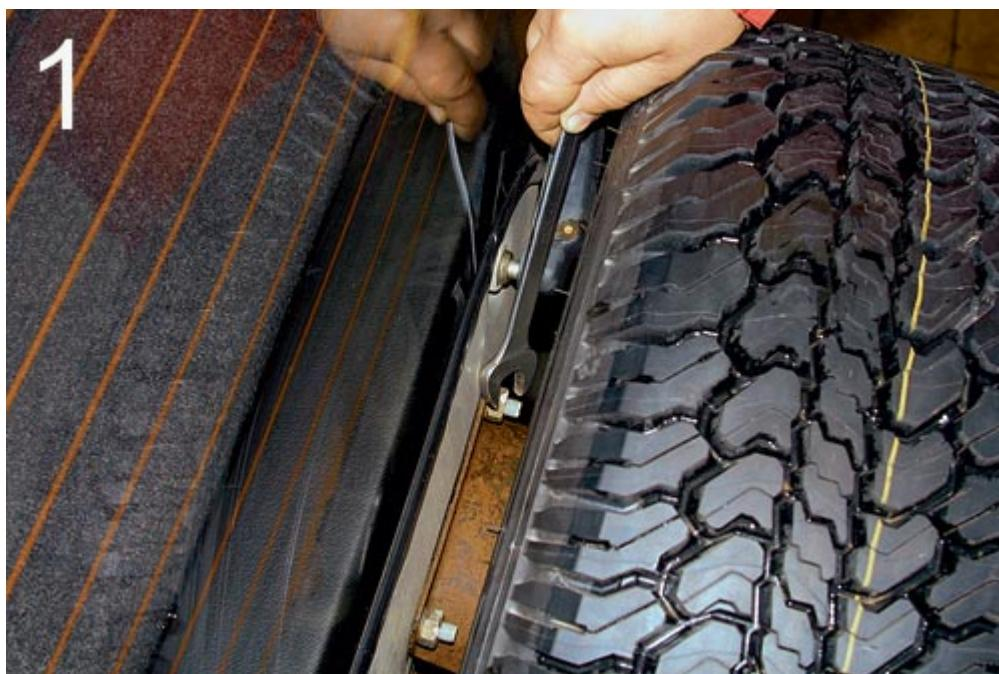
Как обезопасить автомобиль от этих бед? Первый способ – поставить «секретные» гайки на шпильки крепления колеса к кронштейну и кронштейна к двери. Второй способ – это «секретка» на одной из шпилек для колеса, а кронштейн закрепляем, что называется,
