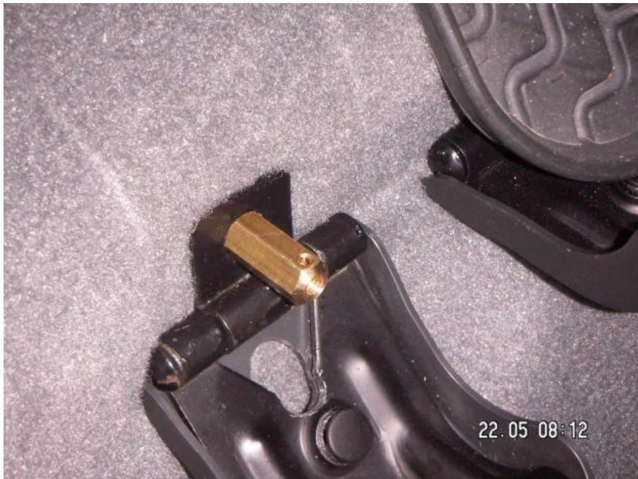
Теперь мы имеем возможность снимать и устанавливать подушку не откидывая ее! Длина гайки подбирается таким образом, чтобы ее можно было отвернуть снаружи, но чтобы она не мешала штатному откидыванию привернутой подушки.
