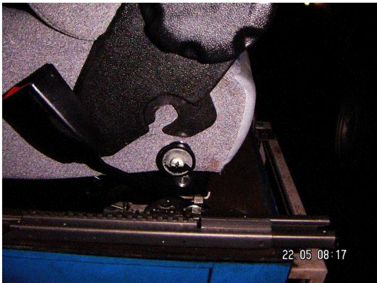
5. Через отверстия имеющиеся на крюках соединяем их тонкой проволокой – выбирая длину петли с тем расчетом чтобы она пряталась за клапан обшивки спинки.
