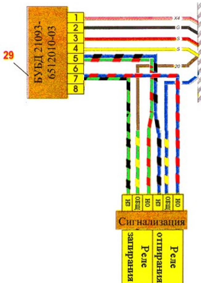
В случае необходимости обратный демонтаж проводки сведётся только к обжиманию новыми клеммами голубого и коричневого проводов.
